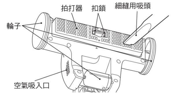
**請求** ●請勿強壓拍打器。拍打器及扣鎖恐會發生破損。
